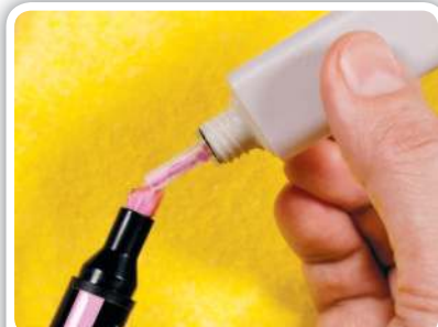
Одноразовые маркеры можно заправлять медленно капая чернила на наконечник
