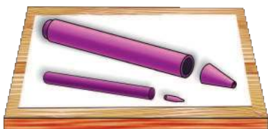
В корпусе маркера находится фетровый фитиль с чернилами, в который вставляется наконечник
