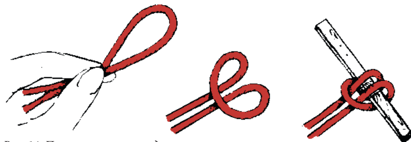
Рис. 14. Прием крепления на деревянную основу длинной нити
