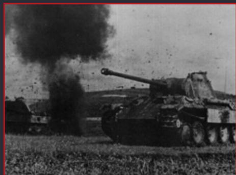
В эксплуатации Т-34 был намного проще, допуская зачастую ремонт силами собственного экипажа. У «Пантеры» же, даже для замены поврежденного катка в ходовой части, если это был каток из внутреннего ряда (катки у этого танка располагались в шахматном порядке ради лучшего распределения нагрузки и боль-
